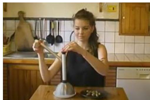
Esercitando quindi una leggera pressione, nell'arco di una frazione di secondo le olive verranno espulse dalla parte inferiore della macchina, perfettamente incise su quattro lati.
